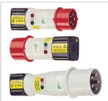
Die Drehstromadapter A3-16, A3-32 und A3-63 dienen dem problemlosen Anschließen von Prüfgeräten an 5-polige CEE-Steckdosen. Die drei Ausführungen unterscheiden sich durch die Größe des Steckers, der jeweils den 5-poligen CEE-Steckdosen mit den Nennströmen 16 A, 32 A, 63 A entspricht. Die Phasenfolge wird jeweils durch Lampen
